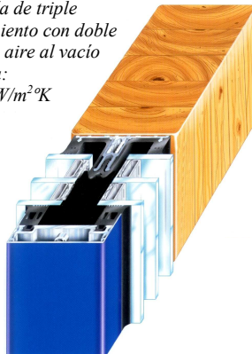
Detalle del flujo energético (calor) en un entresijos ambientados con carpintería de doble vidriado hermético
